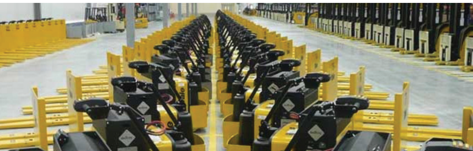
À Balzac, en Alberta, le parc d'appareils de manutention du nouveau Centre de distribution d'aliments périssables de Walmart est entièrement alimenté au moyen de piles à hydrogène
